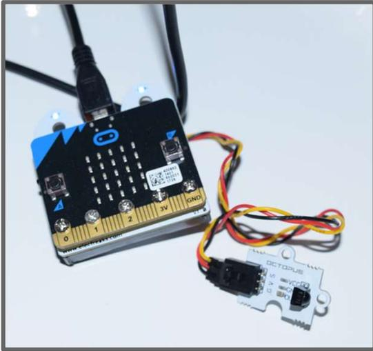
Conecta un sensor IR a la micro:Bit con cables de cocodrilo o gracias a una placa de expansión. En la foto se muestra la placa Ring:Bit con el sensor IR conectado en el PIN 1.
